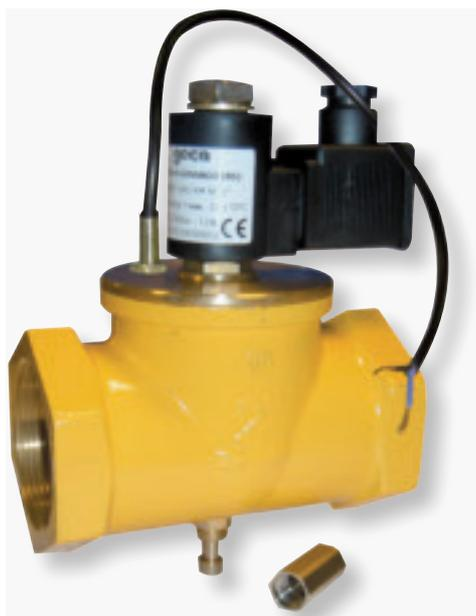
L'elettrovalvola di sicurezza per gas a riarmo manuale con sensore magnetico è una tradizionale elettrovalvola predisposta per avere un dispositivo di lettura dell'effettiva chiusura dell'otturatore sulla sede di tenuta, in modo separato dal sistema di chiusura attraverso la bobina elettromagnetica. Tale dispositivo di sicurezza è di tipo magnetico induttivo normalmente chiuso (dispositivo di fine corsa).
