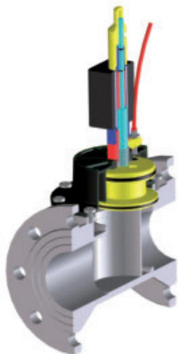
L'elettrovalvola di sicurezza per gas a riarmo manuale con sensore magnetico è una tradizionale elettrovalvola predisposta per avere un dispositivo di lettura dell'effettiva chiusura dell'otturatore sulla sede di tenuta, in modo separato dal sistema di chiusura attraverso la bobina elettromagnetica. Tale dispositivo di sicurezza è di tipo magnetico induttivo normalmente chiuso (dispositivo di fine corsa).
