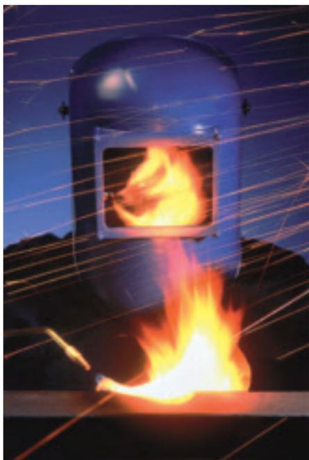
In tutte le attività di carpenteria metallica o comunque dove necessitano delle saldature, è certa la presenza di gas combustibili allo scopo. I più utilizzati sono acetilene e propano oltre ad altri gas dal nome commerciale diverso contenenti additivi per migliorarne le prestazioni.
