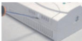
Facendo leva con un cacciavite sbloccare lo sportello per accedere al sensore da sostituire
